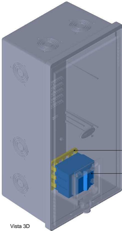
Soporte para interruptor NEMA bipolar o tripolar
